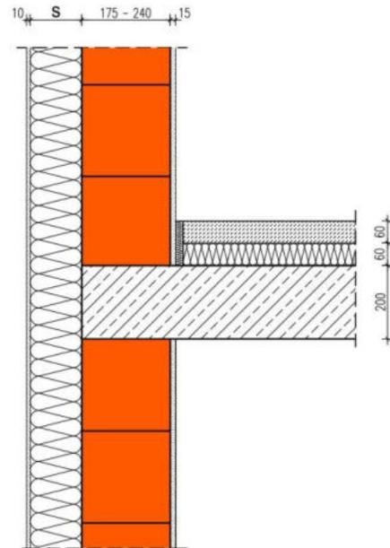
Die Berechnung des längenbezogenen Wärmedurchgangskoeffizienten erfolgt in Abhängigkeit unterschiedlicher Dämmstoffdicken  $S$  des WDVS und Wärmeleitfähigkeiten des Hintermauerwerks für Wanddicken 175 - 240 mm. Die Wärmeleitfähigkeit des WDVS ist mit  $0,035 \text{ W/(m}\cdot\text{K)}$  angenommen.
