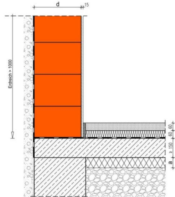
Die Berechnung des längenbezogenen Wärmedurchgangskoeffizienten erfolgt in Abhängigkeit unterschiedlicher Wanddicken  $d$  und Dicken  $a$  der Perimeterdämmung unterhalb der Bodenplatte. Die  $\Psi$ -Werte gelten für Wärmeleitfähigkeiten des Kellermauerwerks  $\leq 0,14 \text{ W/(m}\cdot\text{K)}$ . Der Temperaturkorrekturfaktor  $F_{\text{bw}}$  und  $F_{\text{bf}}$  beträgt 0,6.
