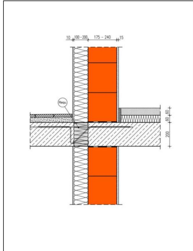
Die Berechnung des längenbezogenen Wärmedurchgangskoeffizienten erfolgt in Abhängigkeit unterschiedlicher Wärmeleitfähigkeiten des Hintermauerwerks der Dicken 175 - 240 mm und verschiedener Wärmedurchlasswiderstände R-äquivalent der Dämmstoffkörper zur thermischen Entkopplung der Balkonplatte. Die Requ - Werte sinken mit zunehmendem Stahlanteil im Dämmelement. Die  $\Psi$ -Werte gelten für Außenwände mit WDVS mit Dämmstoffdicken zwischen 100 und 200 mm. Das Dämmelement hat eine Dicke von 120 mm.
