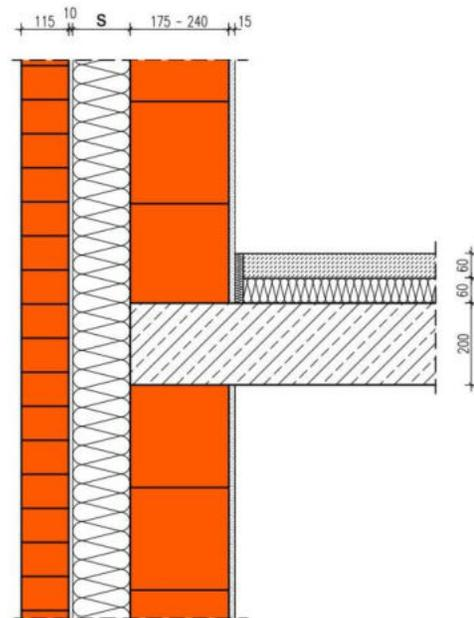
Die Berechnung des längenbezogenen Wärmedurchgangskoeffizienten erfolgt in Abhängigkeit unterschiedlicher Dämmstoffdicken  $S$  des WDVS und Wärmeleitfähigkeiten des Hintermauerwerks für Wanddicken 175 - 240 mm.
