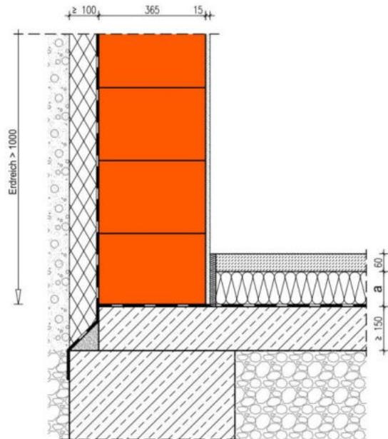
Die Berechnung des längenbezogenen Wärmedurchgangskoeffizienten erfolgt in Abhängigkeit unterschiedlicher Dicken  $a$  der Estrichdämmung und unterschiedlicher Wärmeleitfähigkeiten des Kellermauerwerks mit der Wanddicke 365 und einer Perimeterdämmung mit einer Dicke von mindestens 100 mm. Der Temperatur-Korrekturfaktor  $F_{\text{bw}}$  und  $F_{\text{bf}}$  beträgt 0,6.
