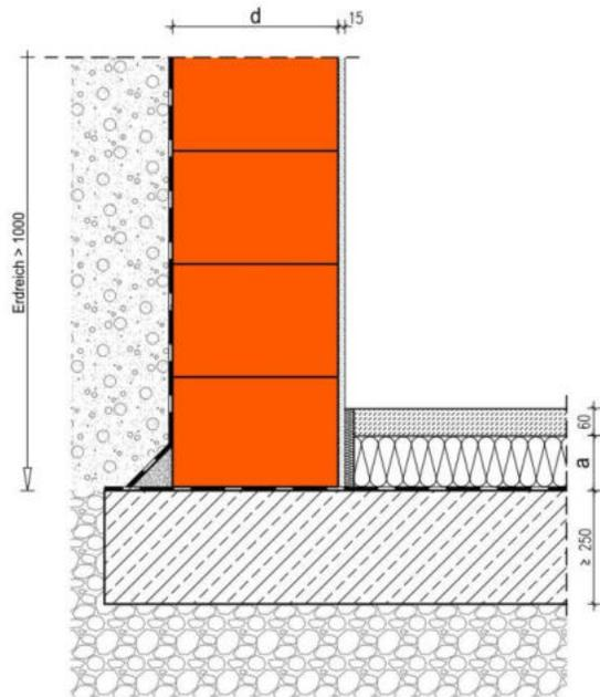
Die Berechnung des längenbezogenen Wärmedurchgangskoeffizienten erfolgt in Abhängigkeit unterschiedlicher Wanddicken  $d$  und Dicken  $a$  der Estrichdämmung. Die  $\Psi$ -Werte gelten für Wärmeleitfähigkeiten des Kellermauerwerks  $\leq 0,14 \text{ W/(m}\cdot\text{K)}$ . Der Temperatur-Korrekturfaktor  $F_{\text{bw}}$  und  $F_{\text{bf}}$  beträgt 0,6.
