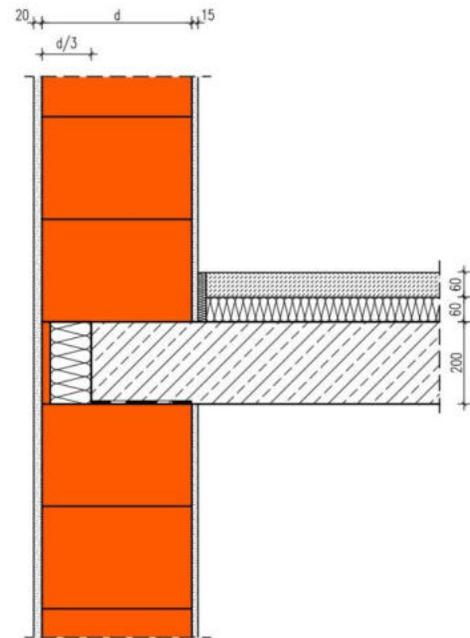
Die Berechnung des längenbezogenen Wärmedurchgangskoeffizienten erfolgt in Abhängigkeit unterschiedlicher Wanddicken d Wärmeleitfähigkeiten des Mauerwerks. Die Dicke der Wärmedämmung hinter der bis zu 20 mm dicken Ziegelblende beträgt zwischen 80 bis 140 mm mit einer Wärmeleitfähigkeit  $\leq 0,035 \text{ W/(m}\cdot\text{K)}$ .
