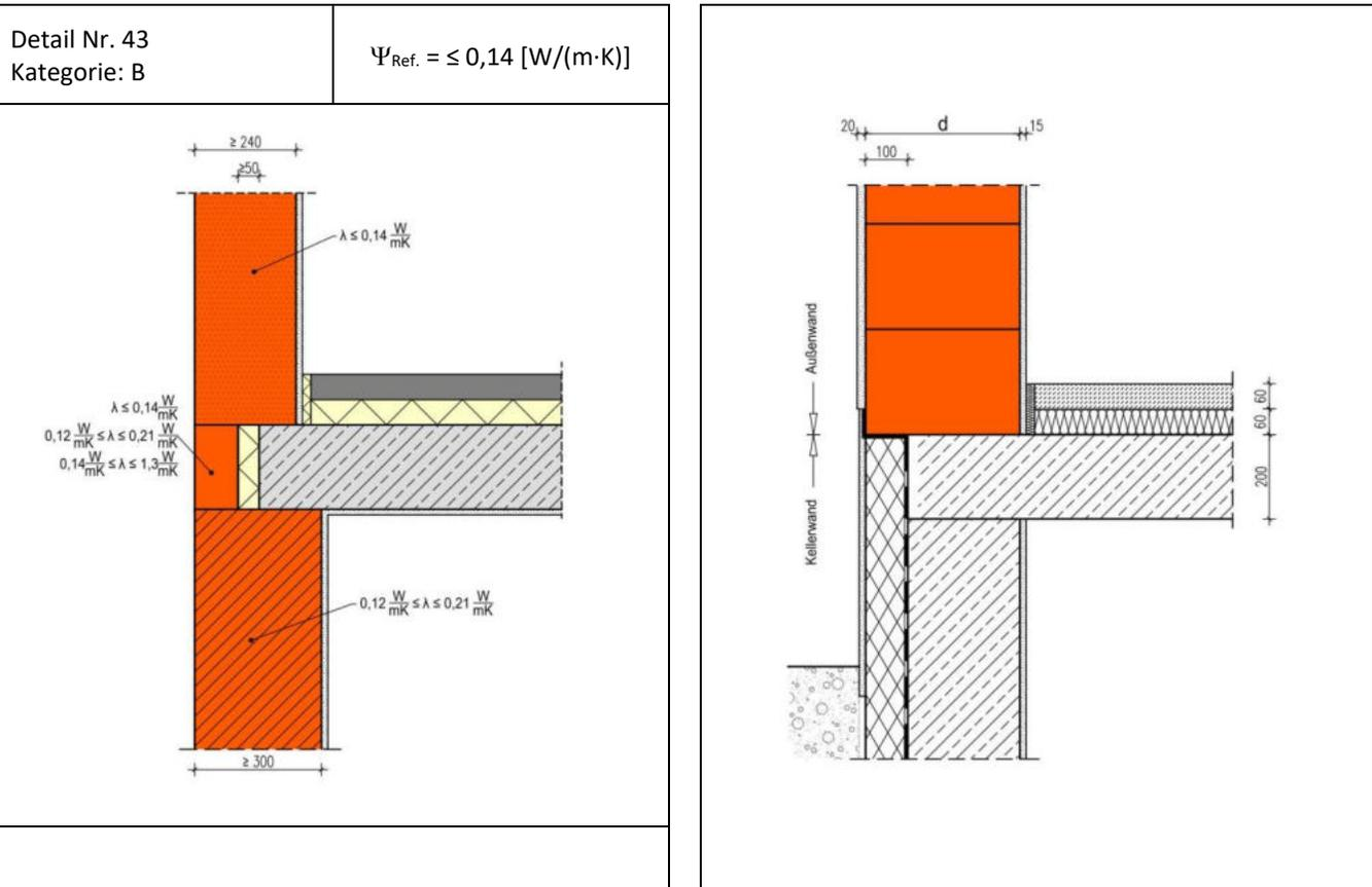
Die Berechnung des längenbezogenen Wärmedurchgangskoeffizienten erfolgt in Abhängigkeit unterschiedlicher Wanddicken  $d$  und Wärmeleitfähigkeiten des Außenmauerwerks im EG.
