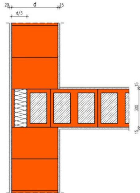
Die Berechnung des längenbezogenen Wärmedurchgangskoeffizienten erfolgt in Abhängigkeit unterschiedlicher Wanddicken  $d$  und Wärmeleitfähigkeiten des Außenmauerwerks. Die 30 cm dicke Wohnungstrennwand ist als Füllziegelwand mit einer Wärmeleitfähigkeit von  $0,96 \text{ W/(m}\cdot\text{K)}$  ausgeführt und mit einer 20 mm Ziegelblende als Putzträgerplatte und Stirndämmung der Wärmeleitfähigkeit  $0,035 \text{ W/(m}\cdot\text{K)}$  mit  $d/3$  in die Außenwand eingebunden.
