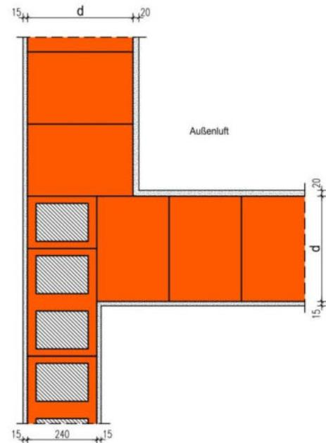
Die Berechnung des längenbezogenen Wärmedurchgangskoeffizienten erfolgt in Abhängigkeit unterschiedlicher Wanddicken  $d$  und Wärmeleitfähigkeiten des Außenmauerwerks. Die 24 cm dicke Wohnungstrennwand ist als Füllziegelwand mit einer Wärmeleitfähigkeit von  $0,96 \text{ W/(m}\cdot\text{K)}$  ausgeführt und mit voller Wanddicke von 24 cm in die abknickende Außenwand eingebunden.
