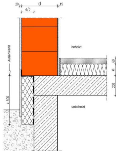
Die Berechnung des längenbezogenen Wärmedurchgangskoeffizienten erfolgt in Abhängigkeit unterschiedlicher Wanddicken  $d$  des Außenmauerwerks im EG und Dicken  $a$  der Estrichdämmung. Die Kellertemperatur beträgt  $10\text{ }^{\circ}\text{C}$ .
