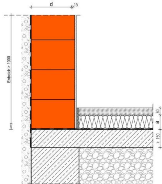
Die Berechnung des längenbezogenen Wärmedurchgangskoeffizienten erfolgt in Abhängigkeit unterschiedlicher Wanddicken  $d$  und Dicken  $a$  der Estrichdämmung. Die  $\Psi$ -Werte gelten für Wärmeleitfähigkeiten des Kellermauerwerks  $\leq 0,14 \text{ W/(m}\cdot\text{K)}$ . Der Temperatur-Korrekturfaktor  $F_{\text{bw}}$  und  $F_{\text{bf}}$  beträgt 0,6.
