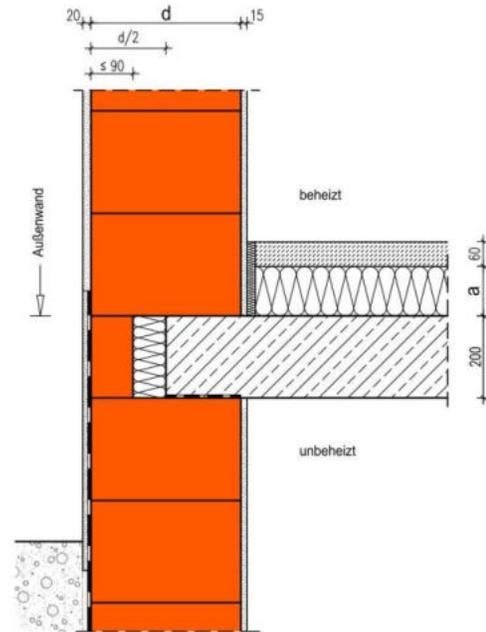
Die Berechnung des längenbezogenen Wärmedurchgangskoeffizienten erfolgt in Abhängigkeit unterschiedlicher Wanddicken  $d$  des Außenmauerwerks im EG und Dämmstoffdicken  $a$  der Estrichdämmung. Die Kellertemperatur beträgt  $10\text{ }^{\circ}\text{C}$ .
