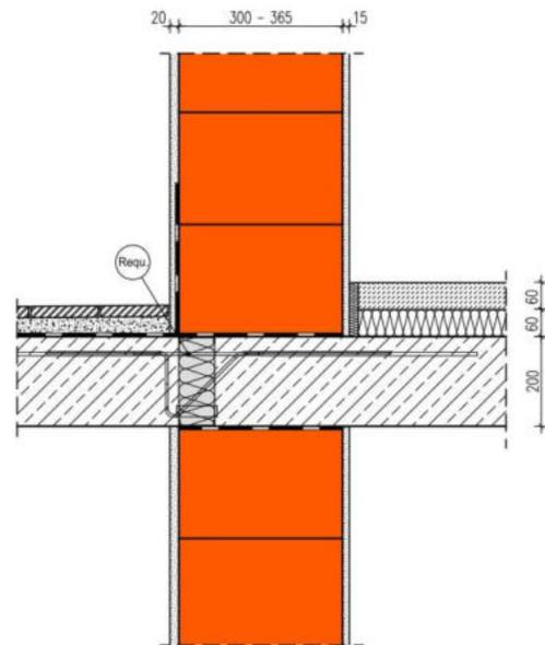
Die Berechnung des längenbezogenen Wärmedurchgangskoeffizienten erfolgt in Abhängigkeit unterschiedlicher Wärmeleitfähigkeiten des Außenmauerwerks und verschiedener Wärmedurchlasswiderstände R-äquivalent der Dämmstoffkörper zur thermischen Entkopplung der Balkonplatte. Die Requ-Werte sinken mit zunehmendem Stahlanteil im Dämmelement. Das Dämmelement hat eine Dicke von 120 mm. Die Rechenergebnisse gelten für Dicken der Außenwände zwischen 300 und 365 mm.
