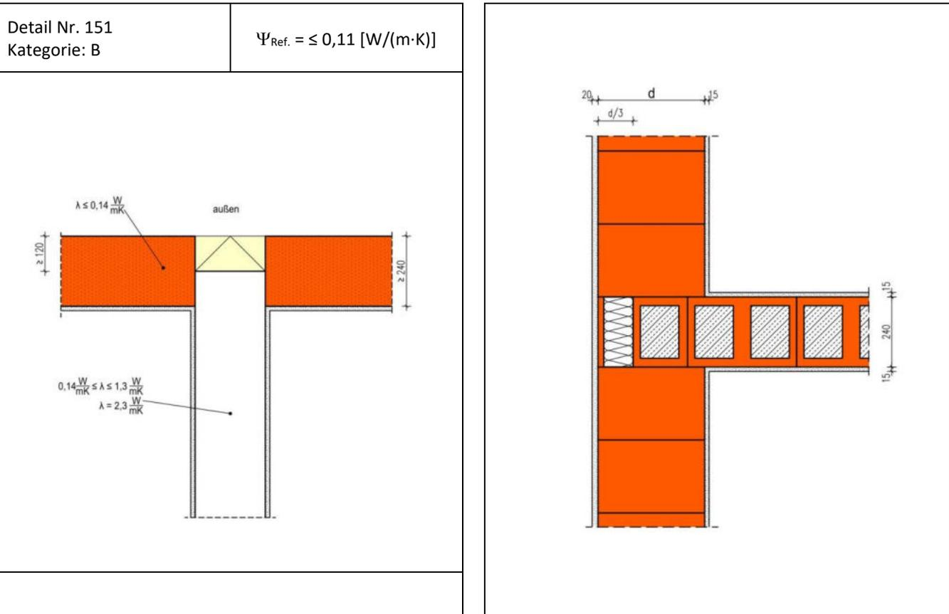
Die Berechnung des längenbezogenen Wärmedurchgangskoeffizienten erfolgt in Abhängigkeit unterschiedlicher Wanddicken d und Wärmeleitfähigkeiten des Außenmauerwerks. Die 24 cm dicke Wohnungstrennwand ist als Füllziegelwand mit einer Wärmeleitfähigkeit von 0,96 W/(m·K) ausgeführt und mit einer 20 mm Ziegelblende als Putzträgerplatte und Stirndämmung der Wärmeleitfähigkeit 0,035 W/(m·K) mit d/3 in die Außenwand eingebunden.
