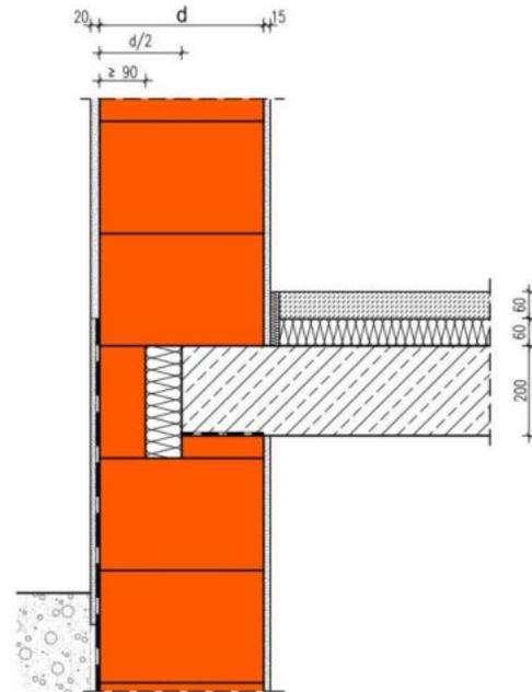
Die Berechnung des längenbezogenen Wärmedurchgangskoeffizienten erfolgt in Abhängigkeit unterschiedlicher Wanddicken  $d$  und Wärmeleitfähigkeiten des Mauerwerks.
