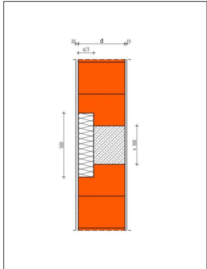
Die Berechnung des längenbezogenen Wärmedurchgangskoeffizienten erfolgt in Abhängigkeit unterschiedlicher Wanddicken  $d$  und Wärmeleitfähigkeiten des Mauerwerks. Die Dicke der Wärmedämmung vor der 300 mm breiten Stahlbetonstütze beträgt  $d/3$  d.h. 100 - 160 mm, deren Wärmeleitfähigkeit 0,035 W/(m·K).
