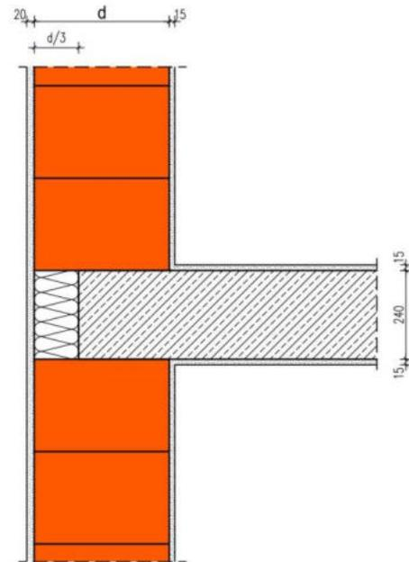
Die Berechnung des längenbezogenen Wärmedurchgangskoeffizienten erfolgt in Abhängigkeit unterschiedlicher Wanddicken  $d$  und Wärmeleitfähigkeiten des Außenmauerwerks. Die 24 cm dicke Wohnungstrennwand ist als Stahlbetonwand berechnet und mit einer  $d/3$  Stirndämmung der Wärmeleitfähigkeit  $0,035 \text{ W/(m}\cdot\text{K)}$  in die Außenwand eingebunden.
