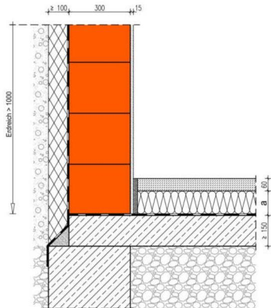
Die Berechnung des längenbezogenen Wärmedurchgangskoeffizienten erfolgt in Abhängigkeit unterschiedlicher Dicken  $a$  der Estrichdämmung und unterschiedlicher Wärmeleitfähigkeiten des Kellermauerwerks mit der Wanddicke 300 und einer Perimeterdämmung mit einer Dicke von mindestens 100 mm. Der Temperatur-Korrekturfaktor  $F_{\text{bw}}$  und  $F_{\text{bf}}$  beträgt 0,6.
