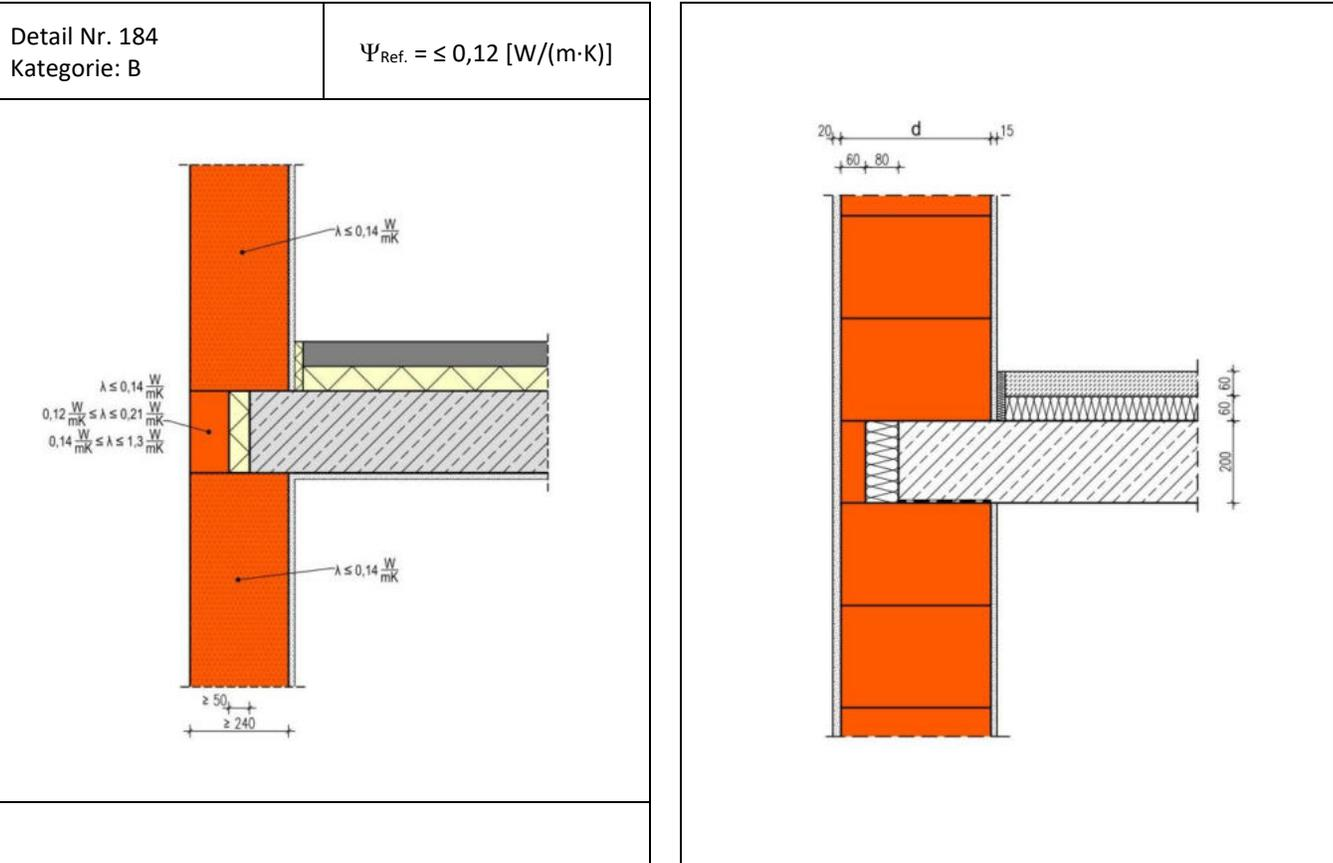
Die Berechnung des längenbezogenen Wärmedurchgangskoeffizienten erfolgt in Abhängigkeit unterschiedlicher Wanddicken d Wärmeleitfähigkeiten des Mauerwerks. Die Dicke der Wärmedämmung hinter der 60 mm Ziegel-Deckenrandschale beträgt 80 mm mit einer Wärmeleitfähigkeit  $\leq 0,035 \text{ W}/(\text{m}\cdot\text{K})$ .
