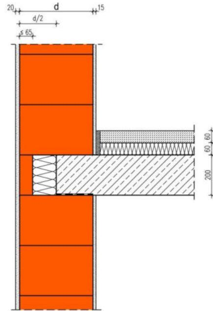
Die Berechnung des längenbezogenen Wärmedurchgangskoeffizienten erfolgt in Abhängigkeit unterschiedlicher Wanddicken d Wärmeleitfähigkeiten des Mauerwerks. Die Dicke der Wärmedämmung hinter dem 60 mm Deckenabmauerziegel beträgt zwischen 70 bis 120 mm mit einer Wärmeleitfähigkeit  $\leq 0,035 \text{ W/(m}\cdot\text{K)}$ .
