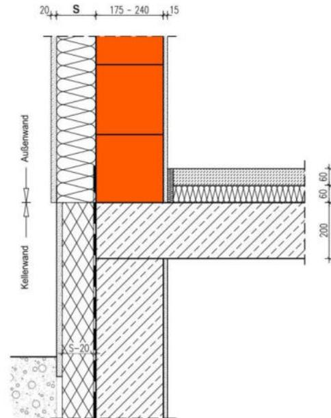
Die Berechnung des längenbezogenen Wärmedurchgangskoeffizienten erfolgt in Abhängigkeit unterschiedlicher Dämmstoffdicken  $s$  des WDVS und Wärmeleitfähigkeiten des Hintermauerwerks im EG für Wanddicken 175 - 240 mm.
