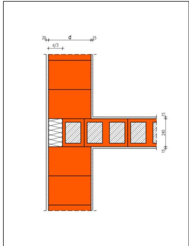
Die Berechnung des längenbezogenen Wärmedurchgangskoeffizienten erfolgt in Abhängigkeit unterschiedlicher Wanddicken  $d$  und Wärmeleitfähigkeiten des Außenmauerwerks. Die 24 cm dicke Wohnungstrennwand ist als Füllziegelwand mit einer Wärmeleitfähigkeit von  $0,96 \text{ W/(m}\cdot\text{K)}$  ausgeführt und mit einer  $d/3$  Stirndämmung der Wärmeleitfähigkeit  $0,035 \text{ W/(m}\cdot\text{K)}$  in die Außenwand eingebunden.
