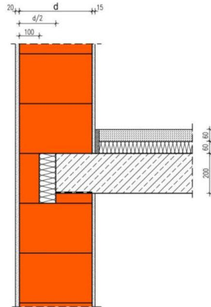
Die Berechnung des längenbezogenen Wärmedurchgangskoeffizienten erfolgt in Abhängigkeit unterschiedlicher Wanddicken  $d$  und Wärmeleitfähigkeiten des Mauerwerks. Die Dicke der Deckenstirndämmung beträgt inklusive Deckenabmauerziegel  $d/2$  mit einer Wärmeleitfähigkeit von  $0,035 \text{ W/(m}\cdot\text{K)}$ . Die Wärmeleitfähigkeit des Abmauerziegels und des Höhenausgleichziegels hat einen zu vernachlässigenden Einfluss auf die  $\Psi$ -Werte.
