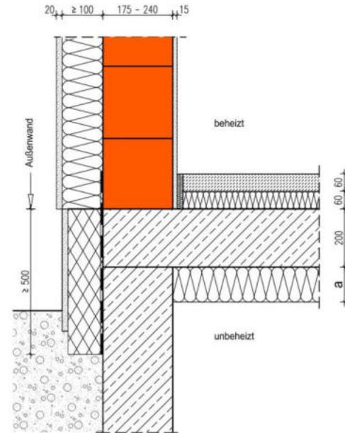
Die Berechnung des längenbezogenen Wärmedurchgangskoeffizienten erfolgt in Abhängigkeit unterschiedlicher Dämmstoffdicken  $a$  der unterseitigen Deckendämmung der Wärmeleitfähigkeit  $0,035 \text{ W/(m}\cdot\text{K)}$  und Wärmeleitfähigkeiten des Hintermauerwerks im EG für die Wanddicken  $175 - 240 \text{ mm}$ . Die Kellertemperatur beträgt  $10 \text{ }^\circ\text{C}$ .
