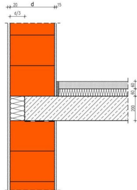
Die Berechnung des längenbezogenen Wärmedurchgangskoeffizienten erfolgt in Abhängigkeit unterschiedlicher Wanddicken  $d$  und Wärmeleitfähigkeiten des Mauerwerks. Die Dicke der Dämmung vor der Deckenstirn beträgt  $d/3$  d.h. zwischen 100 und 160 mm mit einer Wärmeleitfähigkeit von  $0,035 \text{ W/(m}\cdot\text{K)}$ .
