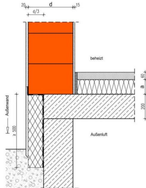
Die Berechnung des längenbezogenen Wärmedurchgangskoeffizienten erfolgt in Abhängigkeit unterschiedlicher Wanddicken  $d$  des Außenmauerwerks im EG und Dämmstoffdicken  $a$  der Estrichdämmung mit einer Wärmeleitfähigkeit von  $0,035 \text{ W/(m}\cdot\text{K)}$ . Eine Sockeldämmung ist nicht erforderlich. Die Tiefgarage weist Außenlufttemperatur auf.
