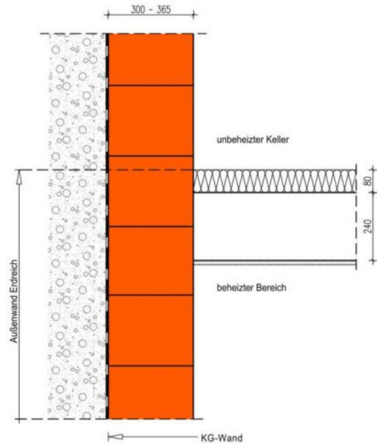
Die Berechnung des langenzugeordneten Warmedurchgangskoeffizienten erfolgt in Abhangigkeit unterschiedlicher Warmeleitfahigkeiten des Auen- und Innenmauerwerks. Die Systemgrenze der Wande verlauft auenseitig auf der Kaltseite (Erdreich bzw. unbeheizter Keller). Der Temperaturkorrekturfaktor  $F_{\text{bw}}$  und  $F_{\text{bf}}$  betragt 0,6. Die Rechenergebnisse gelten fur Wanddicken der Auenwande zwischen 300 und 365 mm.
