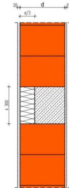
Die Berechnung des langenzugezogenen Warmedurchgangskoeffizienten erfolgt in Abhangigkeit unterschiedlicher Wanddicken  $d$  und Warmeleitfahigkeiten des Mauerwerks. Die Dicke der Warmedammung vor der 300 mm breiten Stahlbetonstutze betragt  $d/3$  d.h. 100 - 160 mm, deren Warmeleitfahigkeit 0,035 W/(m·K).
