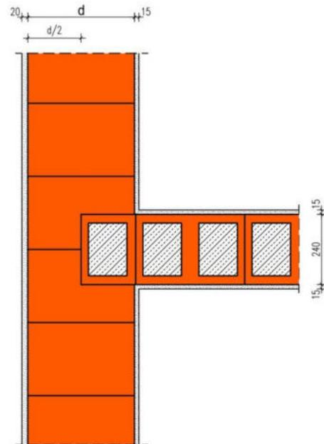
Die Berechnung des längenbezogenen Wärmedurchgangskoeffizienten erfolgt in Abhängigkeit unterschiedlicher Wanddicken  $d$  und Wärmeleitfähigkeiten des Außenmauerwerks. Die 24 cm dicke Wohnungstrennwand ist als Füllziegelwand mit einer Wärmeleitfähigkeit von 0,96 W/(m·K) ausgeführt und etwa  $d/2$  von der Raumseite eingebunden.
