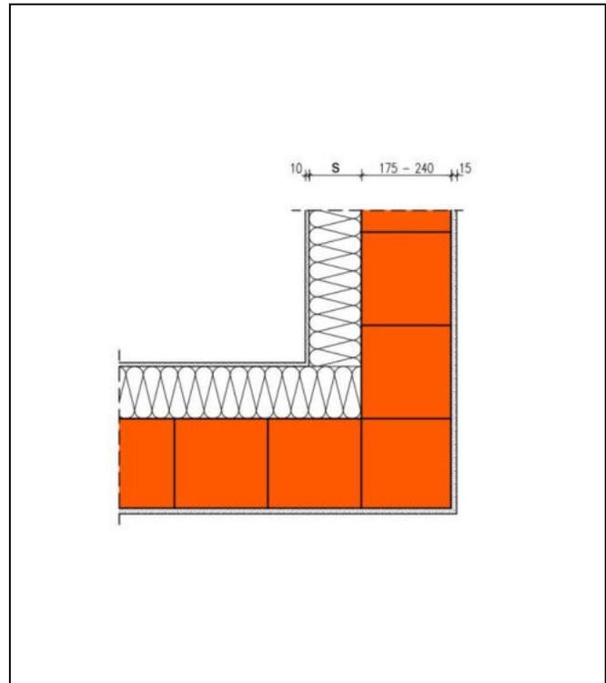
Die Berechnung des längenbezogenen Wärmedurchgangskoeffizienten erfolgt in Abhängigkeit unterschiedlicher Dämmstoffdicken  $s$  und Wärmeleitfähigkeiten des Hintermauerwerks für die Waddicken 175-240 mm. Bei davon abweichenden größeren Waddicken der Hintermauerung ergeben sich geringfügig günstigere  $\Psi$ -Werte.
