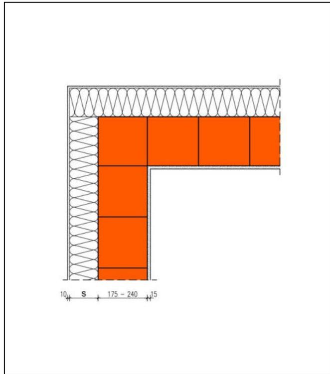
Die Berechnung des längenbezogenen Wärmedurchgangskoeffizienten erfolgt in Abhängigkeit unterschiedlicher Dämmstoffdicken  $s$  und Wärmeleitfähigkeiten des Hintermauerwerks bzw. einer Stahlbetonwand für die Wanddicken 175-240 mm. Bei davon abweichenden größeren Wanddicken der Hintermauerung ergeben sich geringfügig günstigere  $\Psi$ -Werte.
