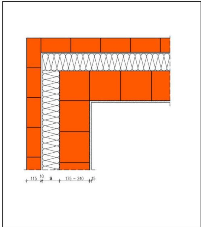
Die Berechnung des längenbezogenen Wärmedurchgangskoeffizienten erfolgt in Abhängigkeit unterschiedlicher Dämmstoffdicken  $s$  und Wärmeleitfähigkeiten des Hintermauerwerks für die Wanddicken 175-240 mm. Bei davon abweichenden größeren Wanddicken der Hintermauerung ergeben sich geringfügig günstigere  $\Psi$ -Werte. Die  $\Psi$ -Werte gelten auch für Dicken der Vormauerschale  $\geq 90$  mm.
