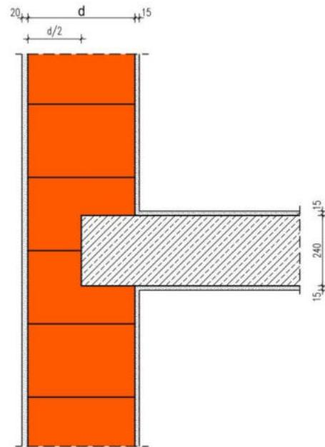
Die Berechnung des längenbezogenen Wärmedurchgangskoeffizienten erfolgt in Abhängigkeit unterschiedlicher Wanddicken  $d$  und Wärmeleitfähigkeiten des Außenmauerwerks. Die 24 cm dicke Wohnungstrennwand ist als Stahlbetonwand berechnet und etwa  $d/2$  von der Raumseite eingebunden.
