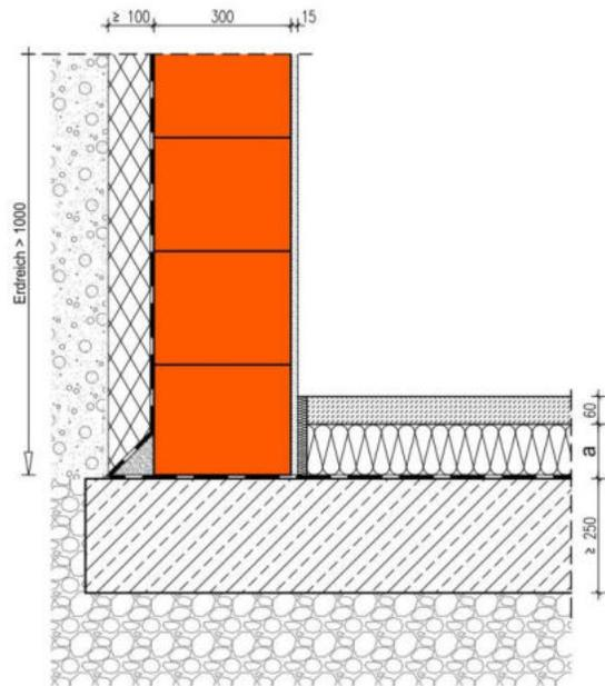
Die Berechnung des längenbezogenen Wärmedurchgangskoeffizienten erfolgt in Abhängigkeit unterschiedlicher Dicken  $a$  der Estrichdämmung und unterschiedlicher Wärmeleitfähigkeiten des Kellermauerwerks mit der Wanddicke 300 mm und einer Perimeterdämmung mit einer Dicke von mindestens 100 mm. Der Temperatur-Korrekturfaktor  $F_{\text{bw}}$  und  $F_{\text{bf}}$  beträgt 0,6.
