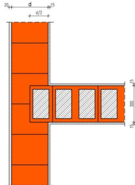
Die Berechnung des längenbezogenen Wärmedurchgangskoeffizienten erfolgt in Abhängigkeit unterschiedlicher Wanddicken  $d$  und Wärmeleitfähigkeiten des Außenmauerwerks. Die 30 cm dicke Wohnungstrennwand ist als Füllziegelwand mit einer Wärmeleitfähigkeit von  $0,09 \text{ W/(m}\cdot\text{K)}$  ausgeführt und etwa  $d/2$  von der Raumseite eingebunden.
