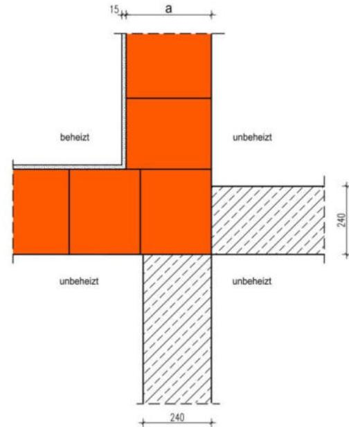
Die Berechnung des längenbezogenen Wärmedurchgangskoeffizienten erfolgt in Abhängigkeit unterschiedlicher Wanddicken  $d$  und Wärmeleitfähigkeiten des Kellermauerwerks zwischen beheiztem und unbeheiztem Keller. Der beheizte Bereich wird dreiseitig vom unbeheizten Keller umschlossen. Die Wärmeleitfähigkeit und Dicke der Wände im unbeheizten Keller hat einen zu vernachlässigenden Einfluss auf den  $\Psi$ -Wert. Der Keller weist eine Kellertemperatur von  $10\text{ °C}$  auf.
