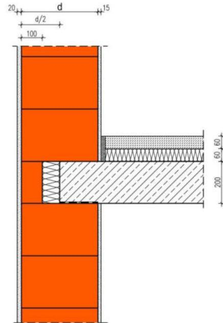
Die Berechnung des längenbezogenen Wärmedurchgangskoeffizienten erfolgt in Abhängigkeit unterschiedlicher Wanddicken  $d$  und Wärmeleitfähigkeiten des Mauerwerks. Die Dicke der Deckenstirndämmung beträgt inklusive Abmauerziegel  $d/2$  mit einer Wärmeleitfähigkeit von  $0,035 \text{ W/(m}\cdot\text{K)}$ . Die Wärmeleitfähigkeit des Abmauerziegels hat einen zu vernachlässigenden Einfluss auf die  $\Psi$ -Werte.
