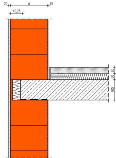
Die Berechnung des längenbezogenen Wärmedurchgangskoeffizienten erfolgt in Abhängigkeit unterschiedlicher Wanddicken  $d$  und Wärmeleitfähigkeiten des Mauerwerks für eine Deckenaufleger mit etwa 75 % der Wanddicke. Die Dicke des Deckenrandelementes aus Ziegelschale und Wärmedämmung beträgt maximal  $0,25 d$  mit einer Wärmeleitfähigkeit des Dämmstoffs  $\leq 0,035 \text{ W/(m}\cdot\text{K)}$ .
