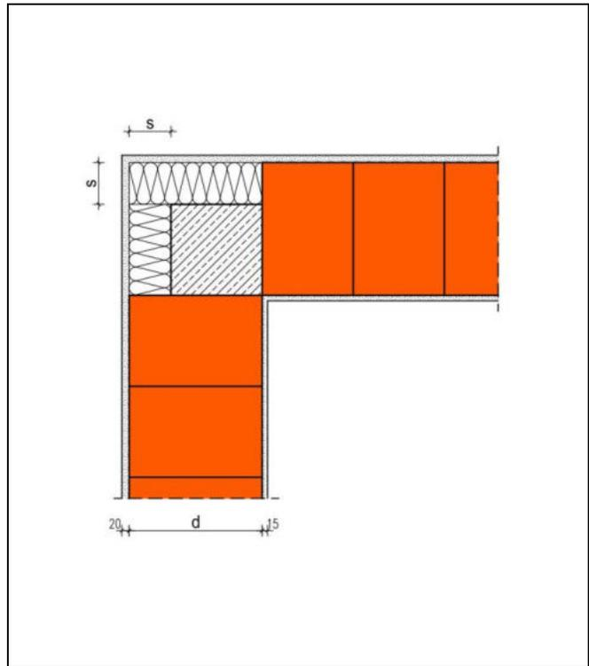
Die Berechnung des längenbezogenen Wärmedurchgangskoeffizienten erfolgt in Abhängigkeit unterschiedlicher Wanddicken  $d$  und Dicken  $a$  der zusätzlichen Wärmedämmung (035) der Stütze. Im Bereich von 3-dimensionalen Außenwanddecken z.B. an Flachdächern sind gfs. besondere Maßnahmen erforderlich, um die Mindestoberflächentemperatur an der Innenoberfläche sicher zu stellen.
