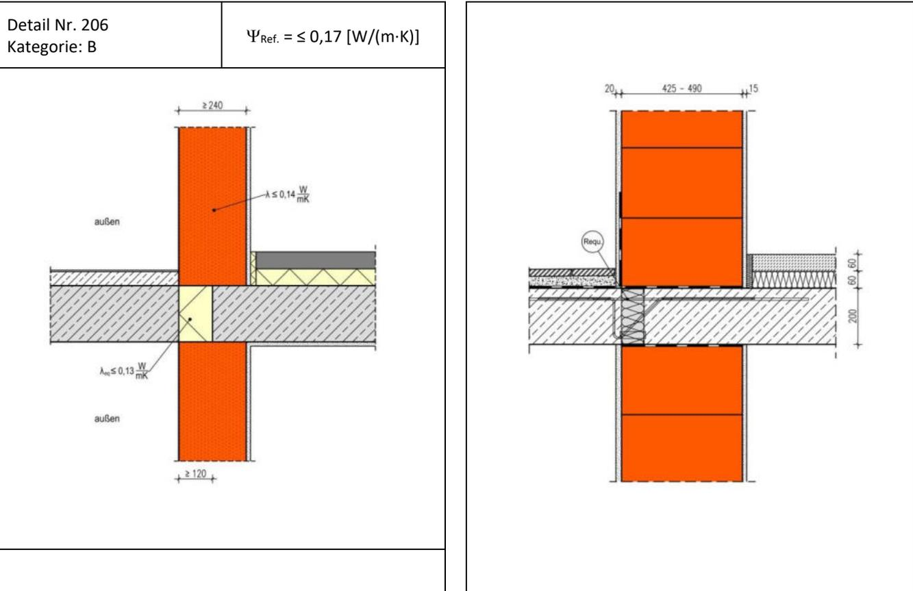
Die Berechnung des längenbezogenen Wärmedurchgangskoeffizienten erfolgt in Abhängigkeit unterschiedlicher Wärmeleitfähigkeiten des Außenmauerwerks und verschiedener Wärmedurchlasswiderstände R-äquivalent der Dämmstoffkörper zur thermischen Entkopplung der Balkonplatte. Die Requ-Werte sinken mit zunehmendem Stahlanteil im Dämmelement. Das Dämmelement hat eine Dicke von 120 mm. Die Rechenergebnisse gelten für Dicken der Außenwände zwischen 425 und 490 mm.
