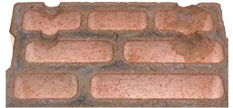
Bild 6. Ausbrechen der Stege in einem Lochziegelstein (links Drehbohren, rechts Hammerbohren)
