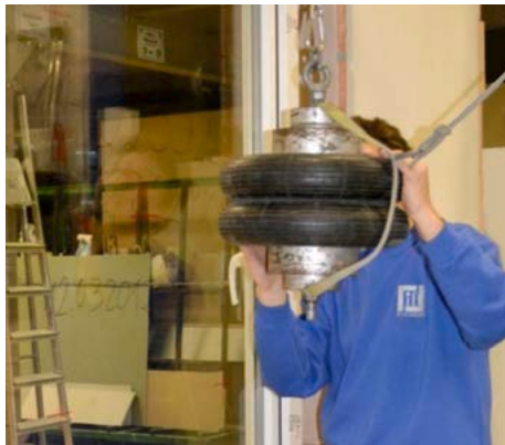
Bild 40. Dynamischer Versuch in der Klasse RC 2 mit einem Doppelreifenpendel (50 kg)
