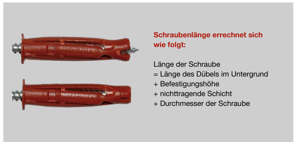
Bild 14. Kunststoffdübel mit korrekter Schraubenlänge und mit nur 5 mm zu kurzer Schraubenlänge
