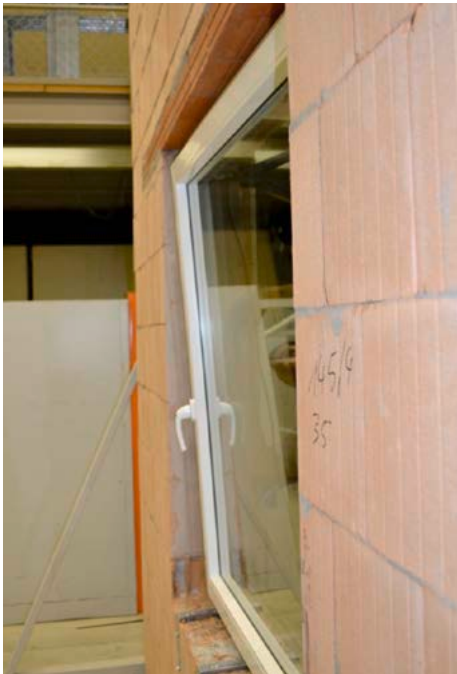
Bild 39. Auslenkung des Fensters bei statischer Prüflast von 3 kN ohne Befestigung oben und ohne seitliche Verklotzung
