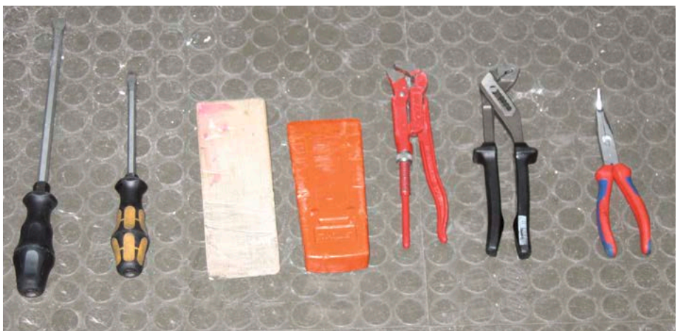
Bild 41. Im Rahmen der Widerstandsklasse RC 2 Prüfung verwendeter Werkzeugsatz
