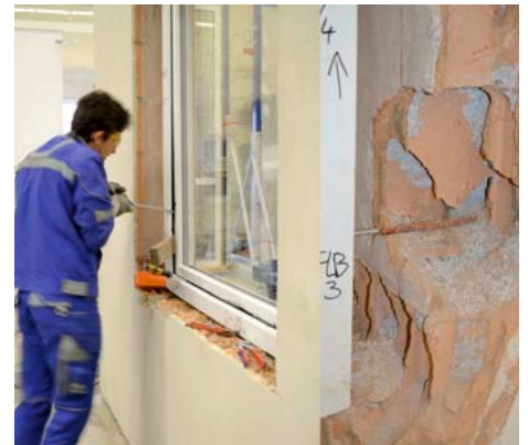
Bild 42. Manuelle Einbruchprüfung mit dem Versuch die Befestigungspunkte freizulegen bzw. durch die Wand selbst zu brechen
