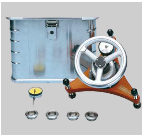
Bild 9. Mobiles Prüfgerät zur Bestimmung der Dübelhaltekräfte auf Baustellen
