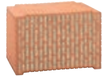
Mineralfaserdämmung, lose \lambda = 0,08 / 0,09 \text{ W/mK} R_{w,1} = 50,1 / 51,8 \text{ dB} f_k = 3,8 / 4,2 \text{ MN/m}^2 (bei SFK 12)
