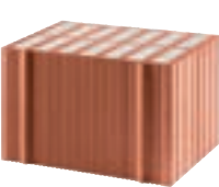
Füllung: Perlite-Dämmstoff \lambda = 0,08 / 0,09 / 0,10 \text{ W/mK} R_{w,1} \geq 48 / 50 / 52 \text{ dB} f_k = 3,0 / 5,3 / 3,6 \text{ MN/m}^2 (SFK 10/12)
