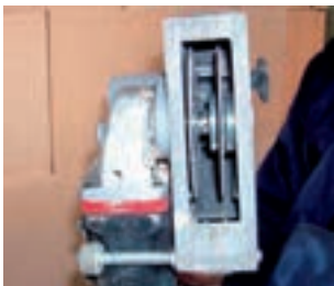
Spezial-Schlitzfräse mit zwei Diamant-trennscheiben und verstellbarer Schnittbreite und -tiefe.
