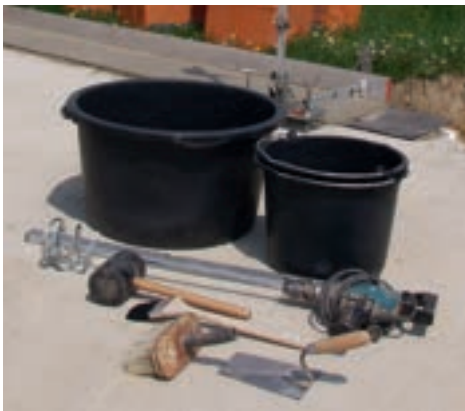
Werkzeug für die Verarbeitung von Planziegeln
