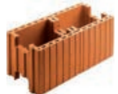
Schalungsziegel für Wohnungs- / Haustrennwände zum Verfüllen mit fließfähigem Beton C12/15, Körnung 0-16 mm mit oder ohne Horizontal- / Vertikalbewehrung R_{w,2}^{(2)} = 57 dB ( t = 17,5 cm) R_{w,2}^{(2)} = 61,4 dB ( t = 24 cm) R_{w,2}^{(2)} = 64,4 dB ( t = 30 cm)
