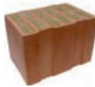
Füllung: Mineralfaserdämmplatten \lambda = 0,09 / 0,10 \text{ W/mK} R_{w,1} = 49,9 / 50,4 \text{ bis } 51,1 \text{ dB} f_k = 3,9 \text{ bis } 5,2 \text{ MN/m}^2 (bei SFK 12)
