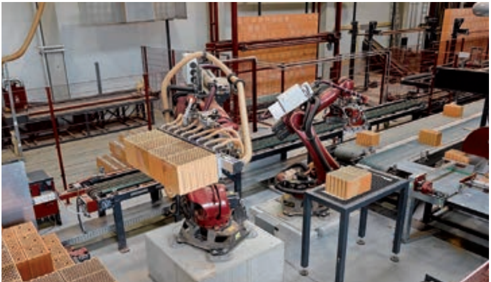
Vollautomatisierte Produktionsanlage zur Vorfertigung von geklebten Ziegel-Wandelementen
