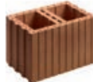
Schallschutz-Füllziegel für Wohnungs- / Haustrennwände zum Verfüllen mit fließfähigem Beton C12/15, Körnung 0-16 mm mit oder ohne Vertikalbewehrung R_{w,2}^{(2)} = 56,9 dB ( t = 17,5 cm) R_{w,2}^{(2)} = 60,8 dB ( t = 24 cm) R_{w,2}^{(2)} = 63,6 dB ( t = 30 cm)
