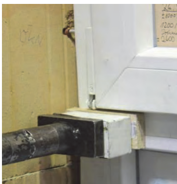
Abbildung 117 Lasteinleitung am Übergangspunkt Riegel Blendrahmen
