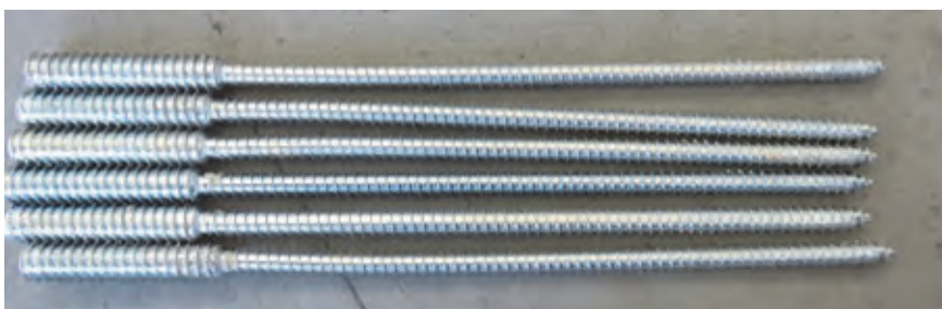
Abbildung 42 Aussehen der Befestigungsmittel des Bauteilversuches mit Wand 2 am Ende der Prüfung
