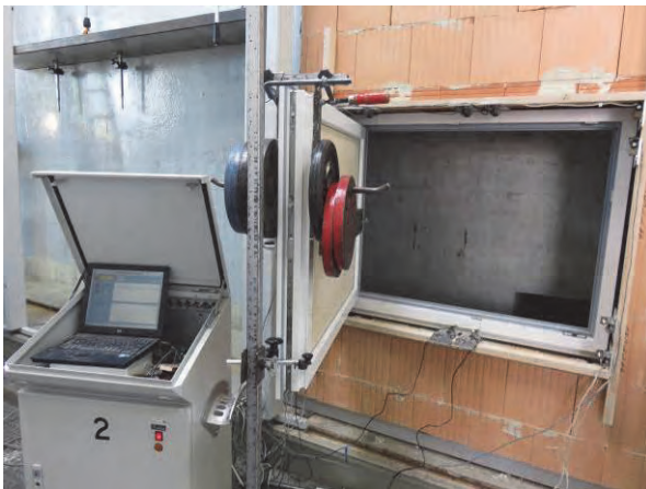
Abbildung 66 Geöffneter Flügel mit zusätzlicher vertikaler Nutzlast von 600 N
