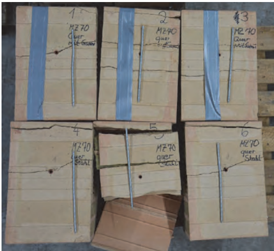
Abbildung 79 Verankerungsgrund (Steintyp 60) und Dübelssystem nach der Versuchsdurchführung am Einzelstein Unten: Versuchsaufbau mit Antirutschmatte Oben: Versuchsaufbau ohne Antirutschmatte
