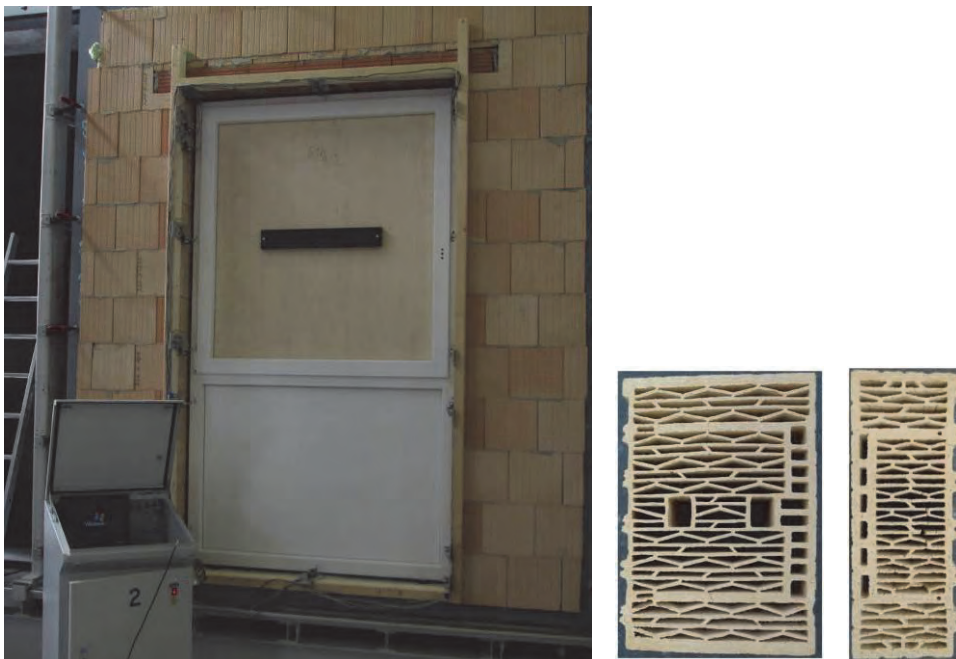
Abbildung 104 Wandaufbau mit Fensterelement sowie verwendete Leibungsziegel
