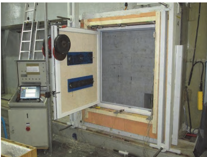
Abbildung 57 90° geöffneter Flügel mit zusätzlicher vertikaler Nutzlast von 600 N
