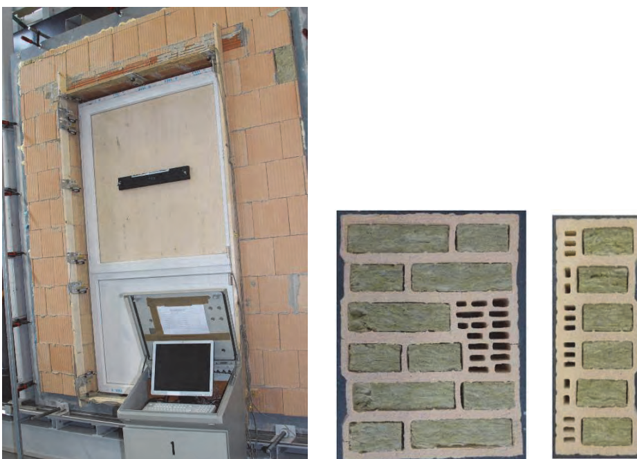
Abbildung 113 Wandaufbau 7 mit Fensterelement sowie verwendete Leibungsziegel
