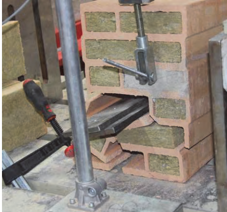
Abbildung 93 Bruch des Planziegels bei der Prüfung Schraube in Schnellzement
