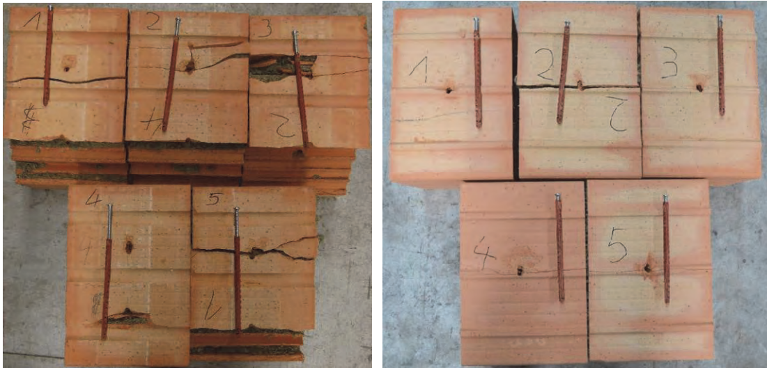
Abbildung 27 Versagensbild der Versuchsserie 19_Q_C (links) sowie 19_Q_E (rechts)
