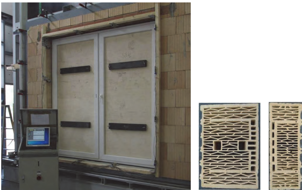
Abbildung 110 Wandaufbau mit Fensterelement sowie verwendete Leibungsziegel
