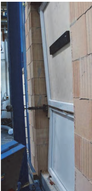
Abbildung 108 Verformung durch Lasteinleitung am Übergangspunkt Riegel Blendrahmen
