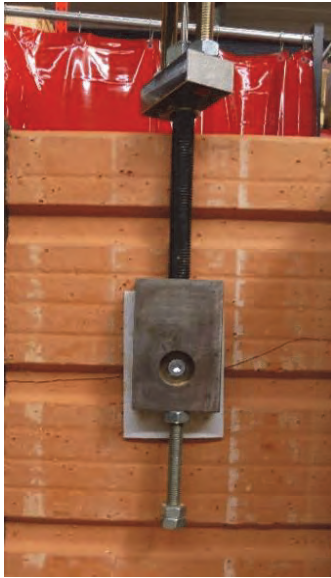
Abbildung 15 Experimentelle Umsetzung Querzugversuche
