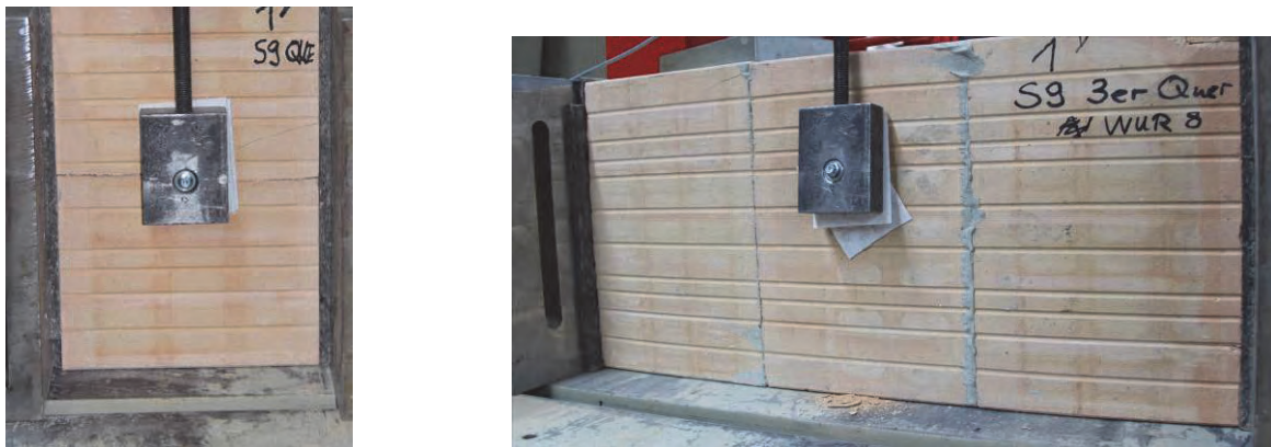
Abbildung 76 Probekörper in der Untersuchung links: Einzelstein rechts: Verband aus 3 Steinen
