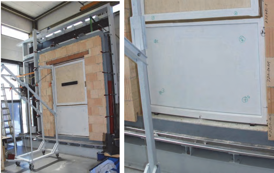
Abbildung 107 Anprall mit Zwillingstreifen, Anprallstellen an der Füllung sowie am Riegel
