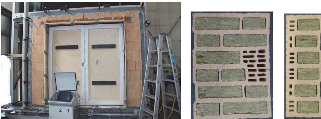
Abbildung 119 Wandaufbau 8 mit Fensterelement sowie verwendete Leibungsziegel
