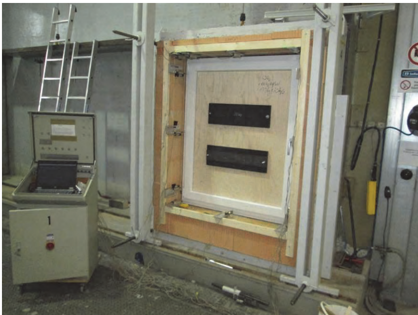
Abbildung 52 Fenster in der Wand montiert mit Zusatzgewichten
