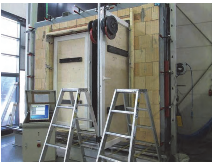
Abbildung 112 Versuchsaufbau zur Simulation der vertikalen Nutzlast
