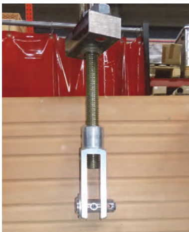
Abbildung 16 Experimentelle Umsetzung der Zugversuche für „Biegung“
