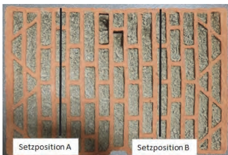
Abbildung 39 Verwendeter Planziegel für Wandaufbau 2
