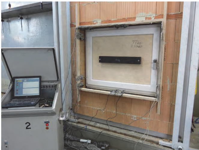
Abbildung 64 Fenster in der Wand montiert mit Zusatzgewichten
