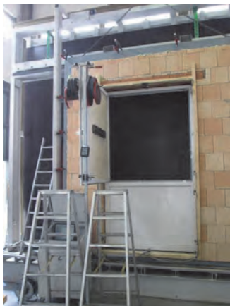
Abbildung 106 Auflastung des Flügel mit 800 N
