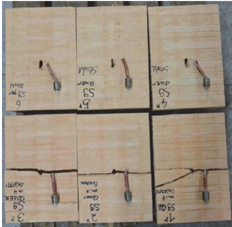
Abbildung 77 Verankerungsgrund (Steintyp 50) und Dübelssystem nach der Versuchsdurchführung am Einzelstein Unten: Versuchsaufbau mit Antirutschmatte Oben: Versuchsaufbau ohne Antirutschmatte
