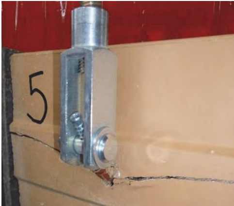
Abbildung 69 Lasteinleitung beim Kleinteilversuch mit freier Verdrehbarkeit
