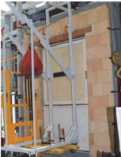
Abbildung 116 Prüfung des Anpralls mit Glaskugelsack nach ETB Richtlinie
