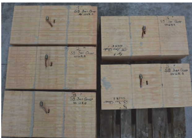
Abbildung 78 Verankerungsgrund (Steintyp 50) und Dübelssystem nach der Versuchsdurchführung am Dreierverband
