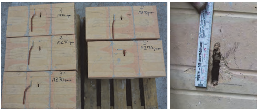
Abbildung 80 Verankerungsgrund (Steintyp 60) und Dübelssystem nach der Versuchsdurchführung am Dreierverband links: Alle untersuchten Probekörper rechts: Detailaufnahme
